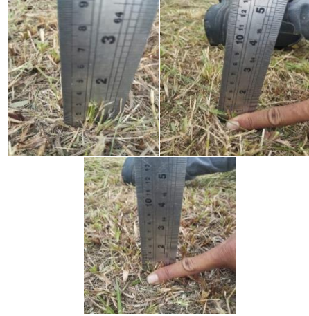
Gambar 22. Pengukuran rumput hasil pengujian pemotongan rumput
