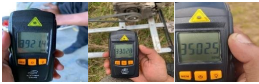
Gambar 19. Pengukuran putaran mesin pemotong rumput
