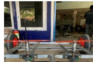
Gambar 13. Pemasangan poros mata pisau
