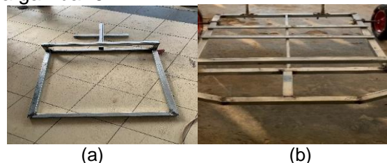
Gambar 2. Perakitan rangka dan dudukan motor penggerak
