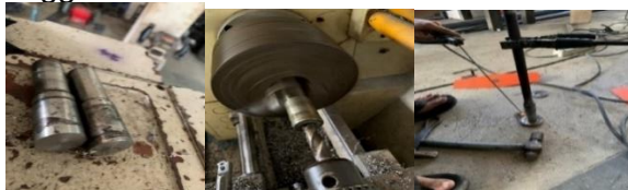
Gambar 5. Proses pembubutan poros pendek mata pisau pemotong rumput
