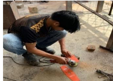
Gambar 8. Proses pengasahan mata pisau pemotong rumput
