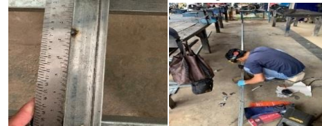
Gambar 4. Pengukuran dan pemotongan profil L
